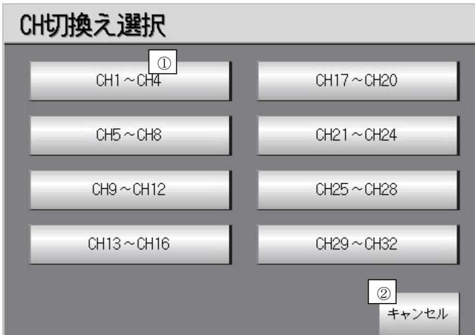
モニタする CHNo.を指定するウィンドウ画面です。オーバーラップウィンドウ 2 画面にて表示する設定となっています。本画面を開くと同時に、通信可能 CH 選択ウィンドウ画面で選択した情報を CF カードから読み出します。
