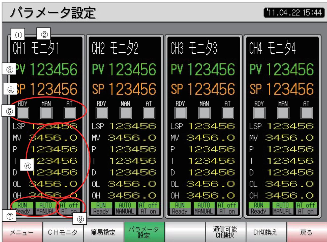
PV、SP、RDY、MAN、AT、LSP、MV、P、I、D、OL、OH を表示します。
